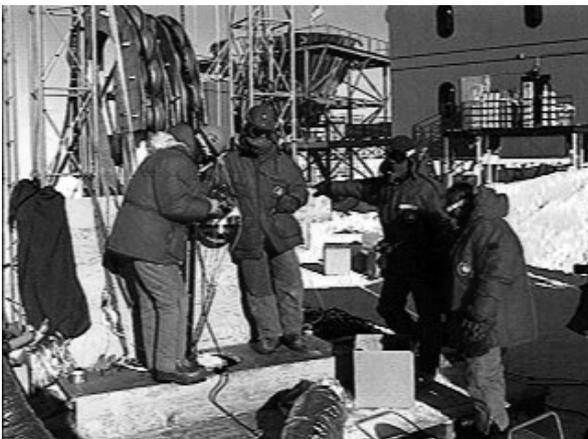
Abb. 3: Der letzte von 216 PMTs wird montiert. Über die Rollen läuft rechts das elektrische Hauptkabel für die Stromversorgung und den
